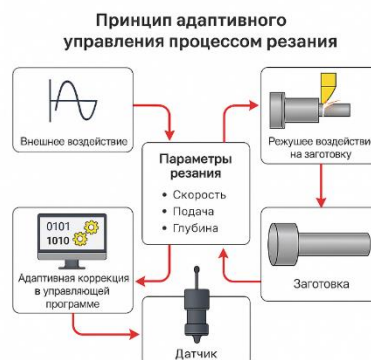
4.2-сурет — Кесу процесін адаптивті басқару принципі
