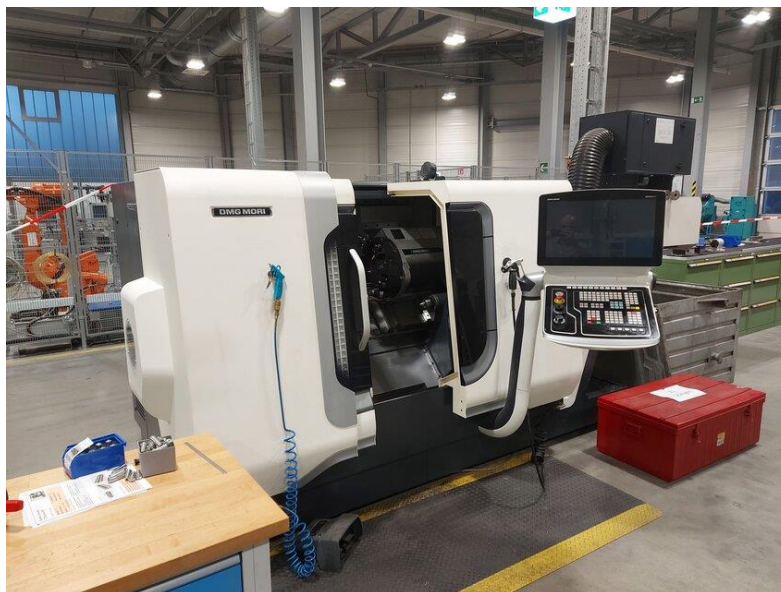
3.1-сурет — Станок DMG MORI CTX Alpha 500
