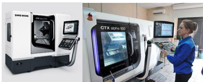
1.3-сурет — Заманауи СББ токарлық-фрезерлік орталық DMG MORI CTX Alpha 50
