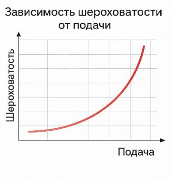
График 1.1 — R_a көрсеткішінің беріліске f -ге тәуелділігі Y осі (тік): Кедір-бұдырлық. X осі (көлденең): Беріліс
