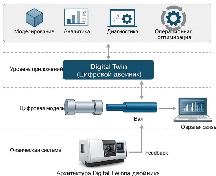
4.3-сурет — Технологиялық процестің сандық егізінің архитектурасы
